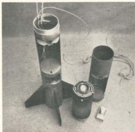
Bauteile der jetzigen Fotorakete: Heck mit aufgebauter Fallschirmkammer I, Fallschirmkammer II, Fotoapparat.
